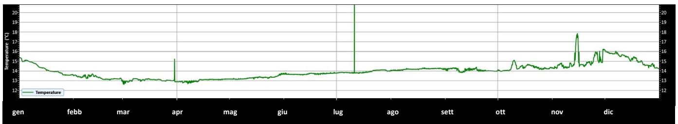
Fig. 3.47 - Andamento della temperatura registrata dal sensore dell'ADCP in prossimità del fondale dal 01/01 al 31/12/2021.
