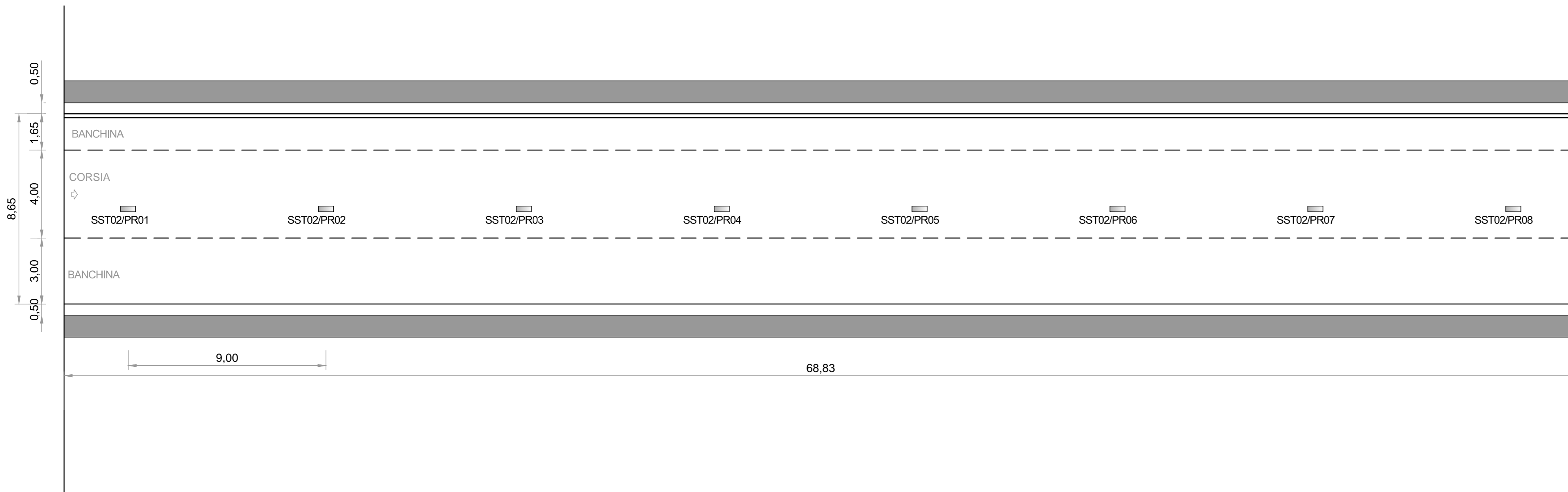
DISPOSIZIONE CORPI ILLUMINANTI SOTTOPASSO SST02 - scala 1:250
