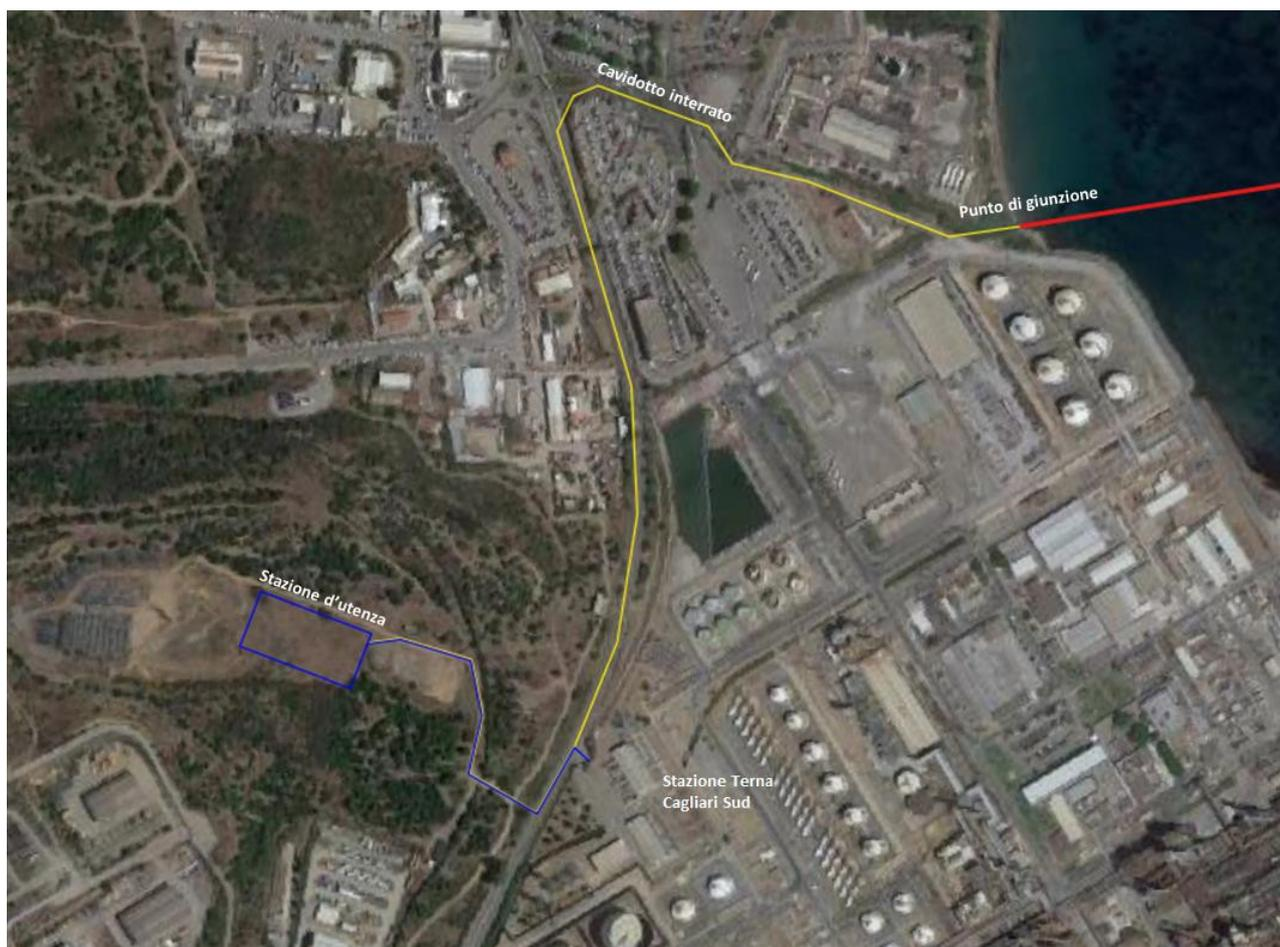
La connessione alla Rete di Trasmissione Nazionale dell'energia elettrica è prevista nei pressi della centrale TERNA "CAGLIARI SUD" nell'area industriale di Cagliari, mediante una sottostazione di misura e consegna da costruire appositamente.
