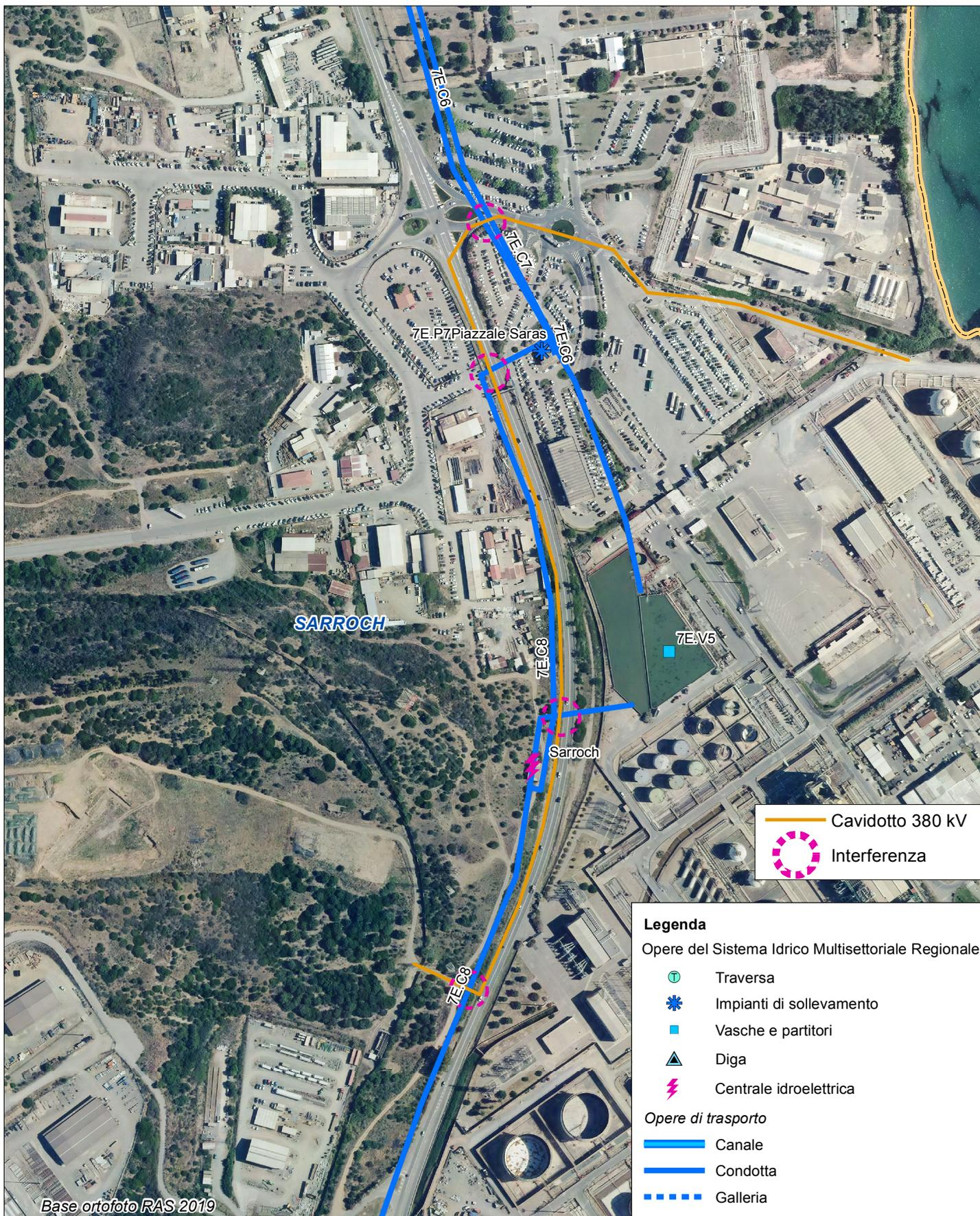
**Individuazione interferenze tra le Opere del Sistema Idrico Multisetoriale Regionale (SIMR) gestito dall'Enas e le opere a terra dell'impianto eolico offshore della Repower Renewable SpA**
