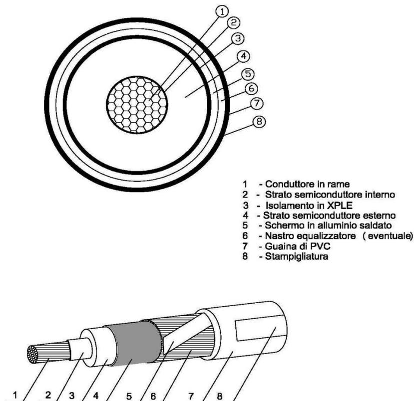
Figura 3 - Schema tipo cavo 150 kV
