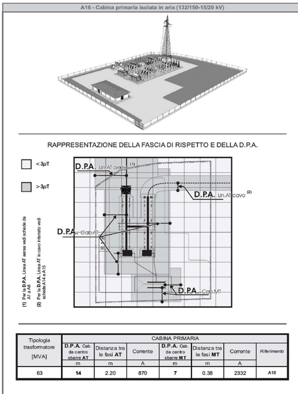
La stazione ad alta tensione, quindi, è caratterizzata da valori di induzione magnetica e di campo elettrico inferiori ai limiti normativi vigenti, in quanto prevalentemente interni al confine della cabina, inoltre la cabina non si trova in adiacenza a nessun luogo in cui è prevista la presenza umana per più di 4 ore.
