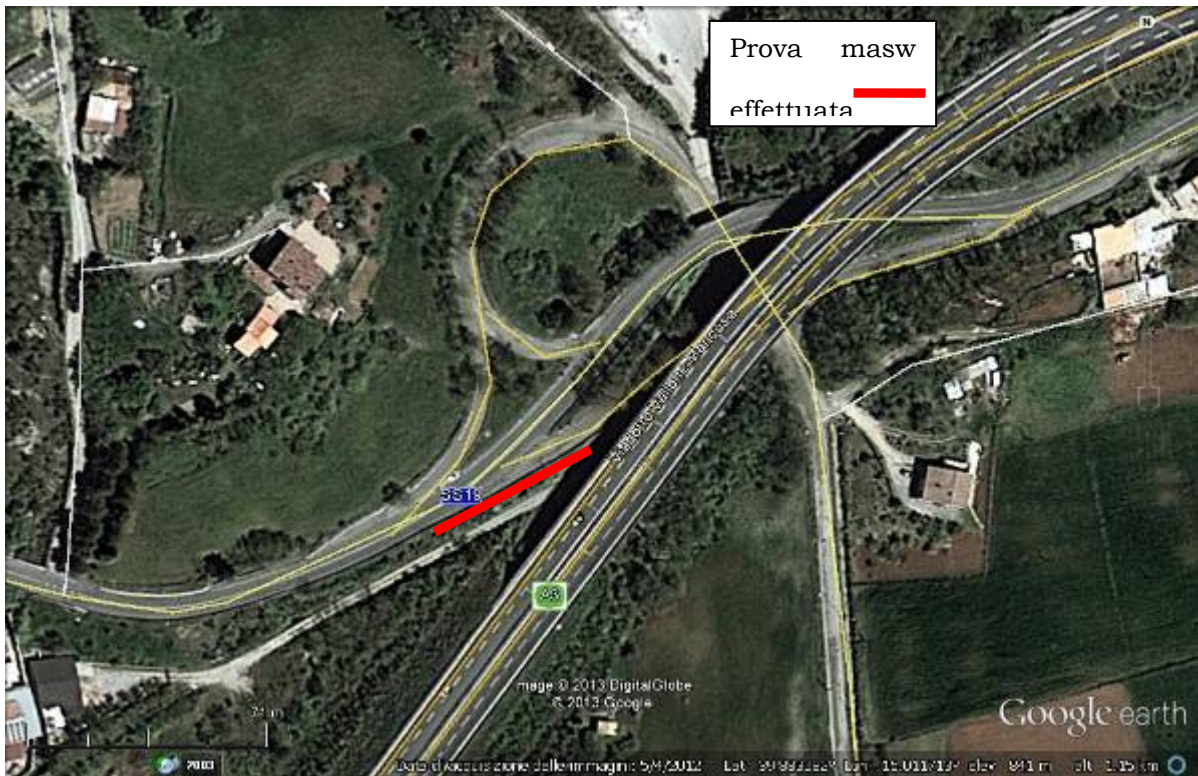
Ubicazione dello stendimento Masw Me30_13
