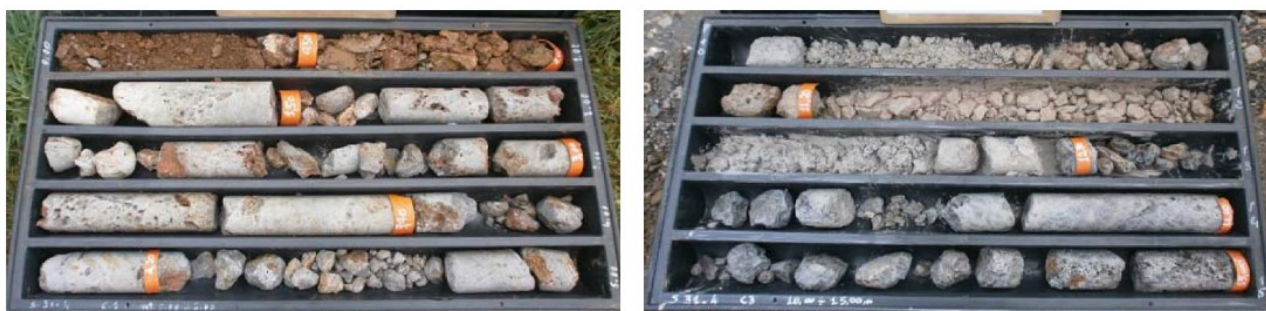
Figura 37– Litologie individuate nel sondaggio Se31_04 nei primi 5 metri dal p.c (a sinistra) e tra i 10-15 (a destra)
