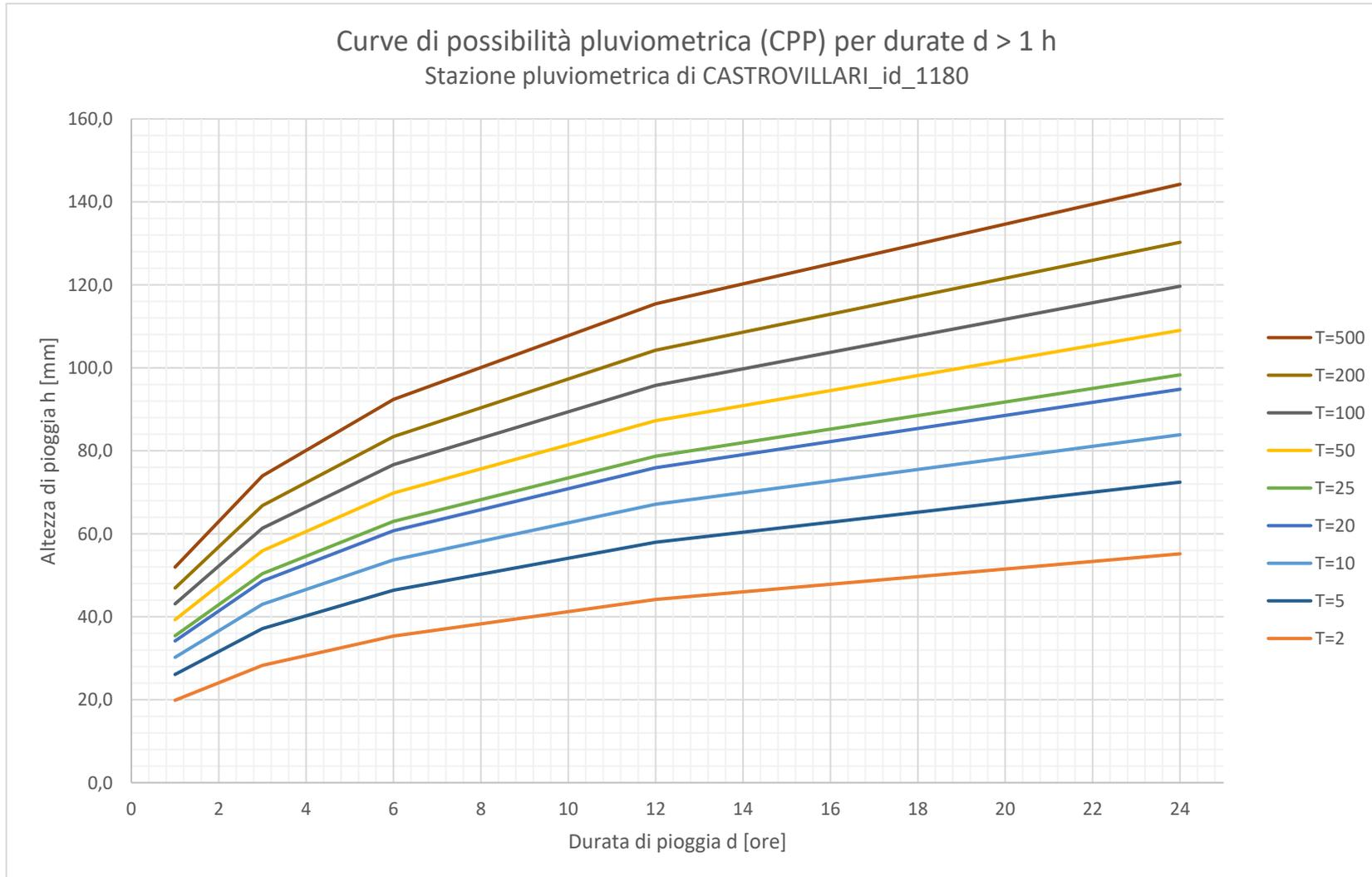
Figura 9: Curve di possibilità pluviometrica per le durate superiori all'ora, per i vari tempi di ritorno. Stazione di Castrovillari.
