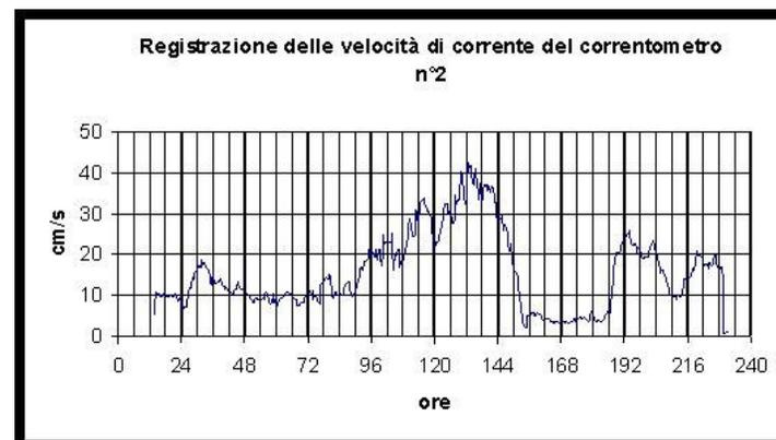
Figura 1.28: Correntometro n. 2 – registrazione della velocità delle correnti
