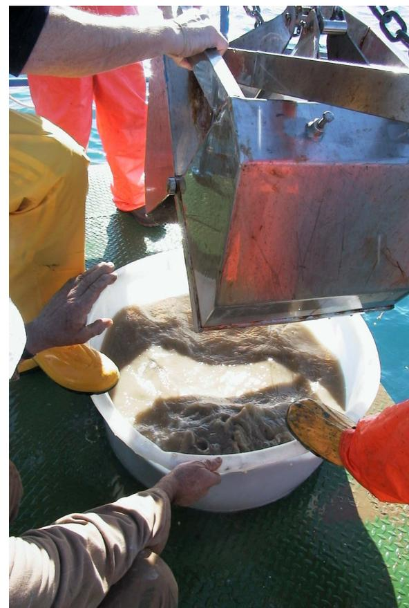
Figura 1.9: Apertura benna e prelievo del sedimento
