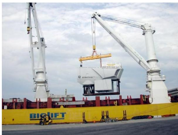
Figura 1.40 Operazione di sbarco di componenti della turbina
