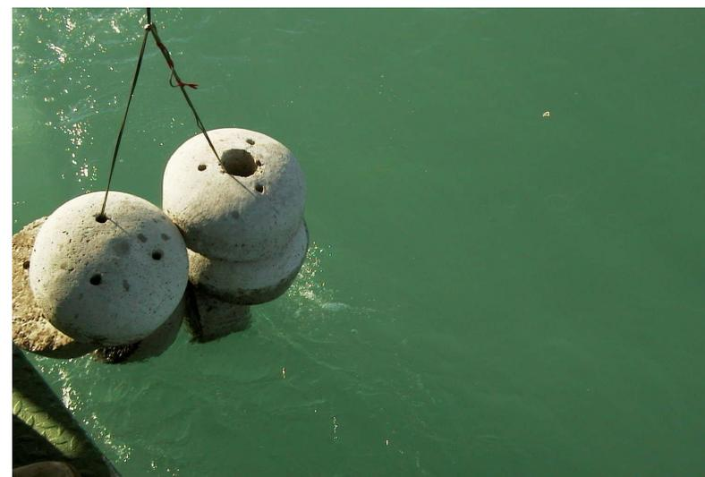
**Figura 1.13: Le zavorre utilizzate per l'ancoraggio dei correntometri**
