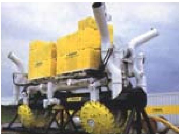
**Figura 1.44** Macchina di scavo, con grosse frese e potenti pompe idrovore
