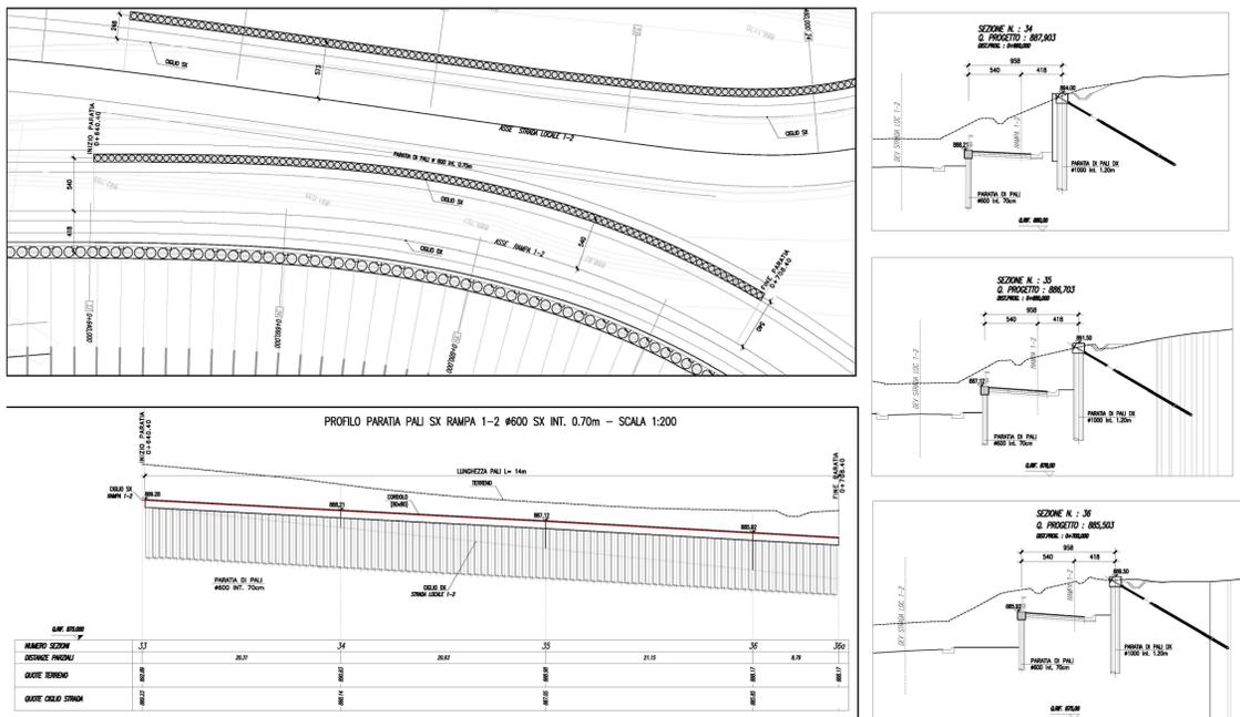
DEVIAZIONE STRADA LOCALE-OS04 MURO DI SOSTEGNO IN SX Pianta, profilo e sezioni trasversali e sezioni
