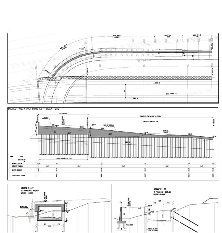
RAMPA 1-2 - OS03 PARATIA DI SOSTEGNO IN SX Pianta, profilo e sezioni trasversali e sezioni
