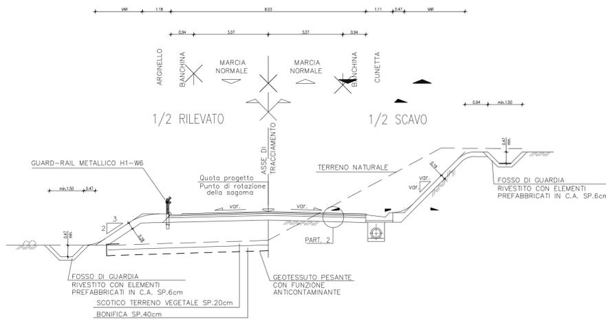
**SEZIONE TIPO PISTA UNIDIREZIONALE CON PARATA DI PALI**
