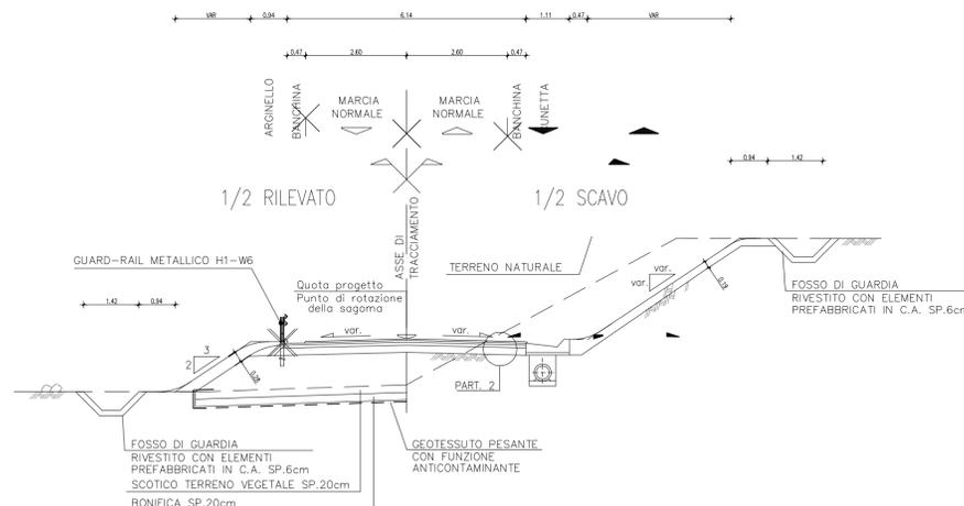
**SEZIONE TIPO ASSE PRINCIPALE CON CORSIA DI SVINCOLO**
