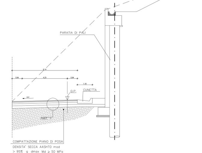
**SEZIONE TIPO PISTA UNIDIREZIONALE IN MEZZACOSTA**
