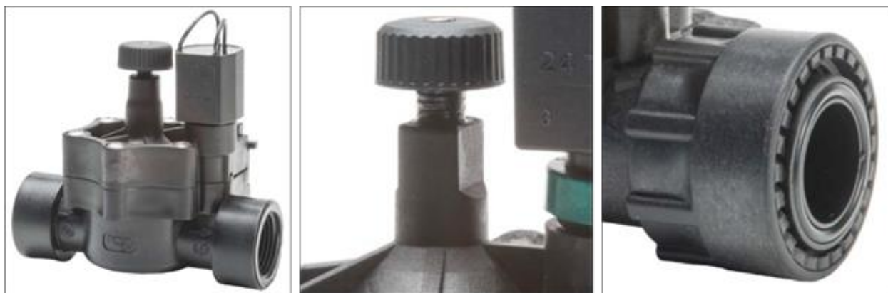
Figura 1 – Elettrovalvola tipo Rain 155 Plus da 1" con attacco 1" M x Union. Nella foto dettaglio del parzializzatore che permette la regolazione del flusso d'acqua in uscita dalla valvola.
