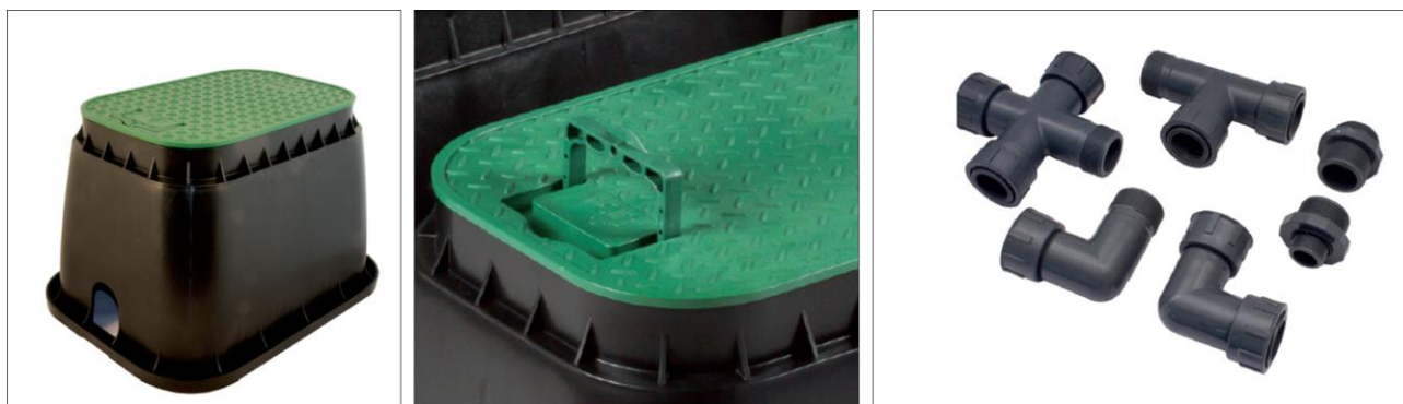
Figura 2 – Pozzetti con maniglia per le valvole e i filtri dell'impianto di irrigazione tipo Rain 115 495 x 660 mm H 330 mm. Sulla destra raccordi in PVC da 2" per la realizzazione del collettore.
