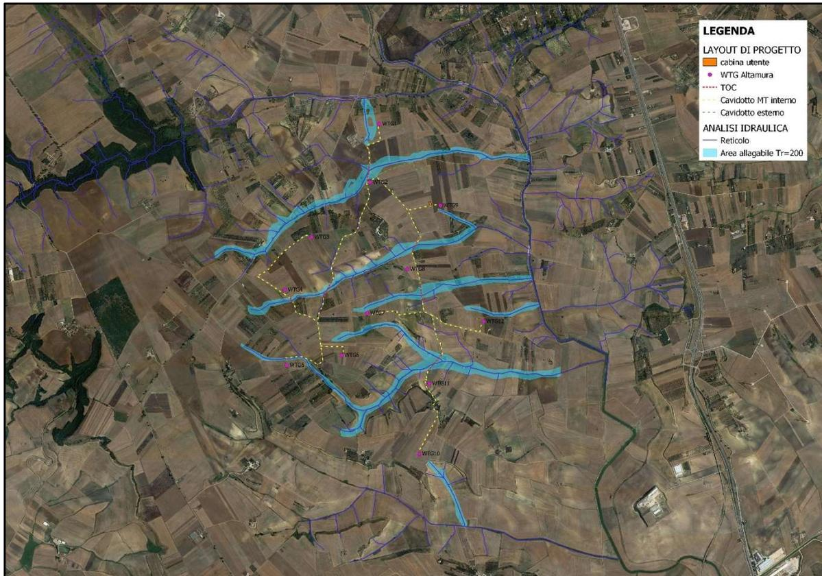
**Figura 17 - Intersezioni tra il cavidotto e il reticolo idrografico con indicazione delle T.O.C.**
