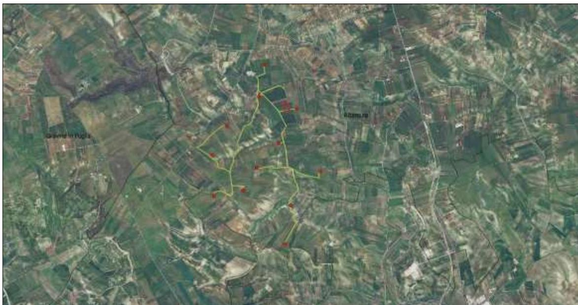
**Figura** – In evidenza su Ortofoto Puglia la localizzazione dei 12 aerogeneratori e opere accessorie (cavidotto e stazione elettrica di servizio all'impianto) in progetto (Elaborazione Studio Rocco Carella).
