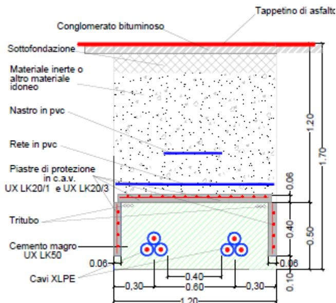
**Figura 2: Tipico sezione della trincea per posa cavo AT 150kV**
