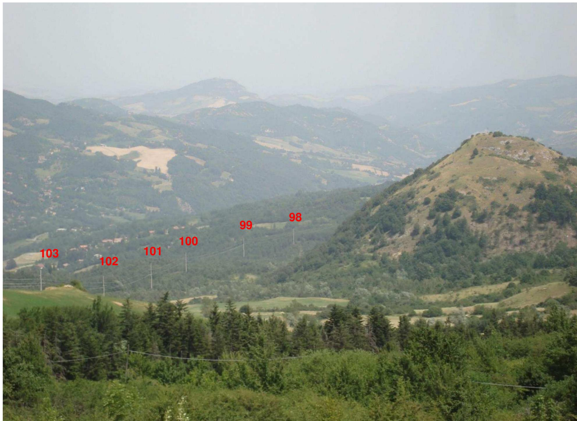
Figura 12: PDV 3 - STATO DI PROGETTO CON SOSTEGNI TUBOLARI - Vista dall'area di sosta panoramica del Passo della Raticosa. Sono visibili i sostegni tubolari 98 (h=46.7), 99 (h=46.7), 100 (h=43.7), 101 (h=46.7), 102 (h=46.7), 103 (h=43.7).
