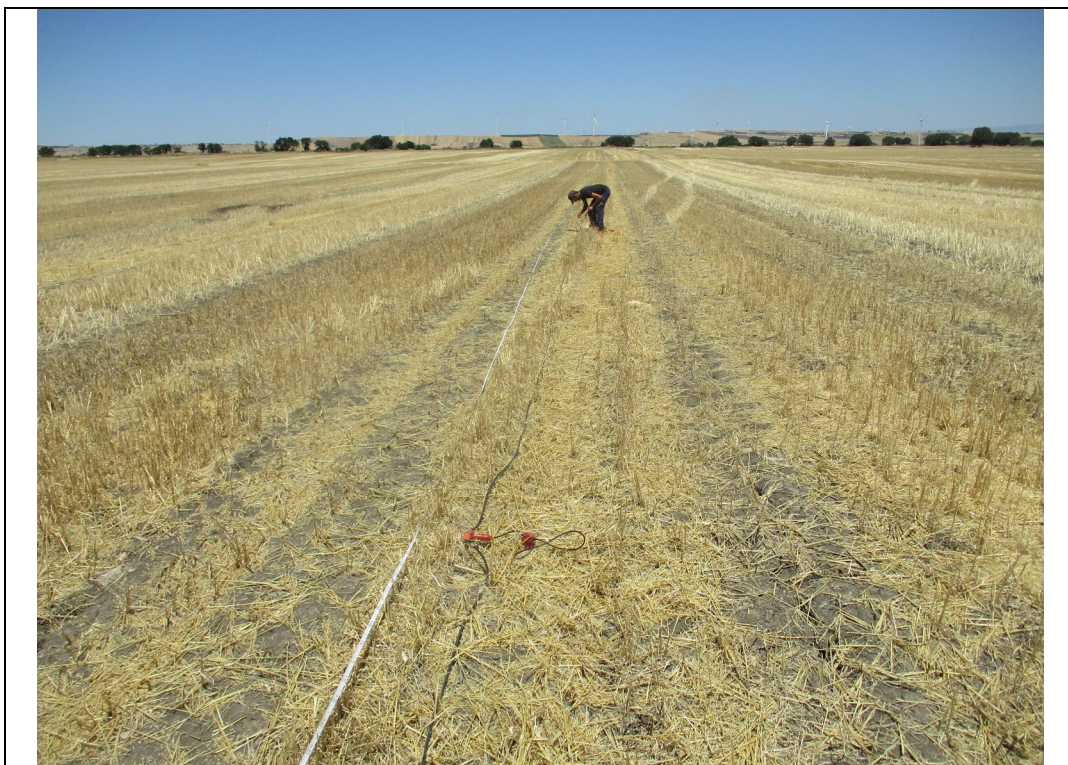
Esecuzione indagine sismica a rifrazione
