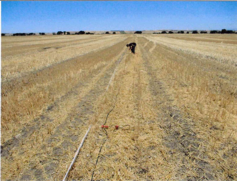
Esecuzione indagine sismica a rifrazione
