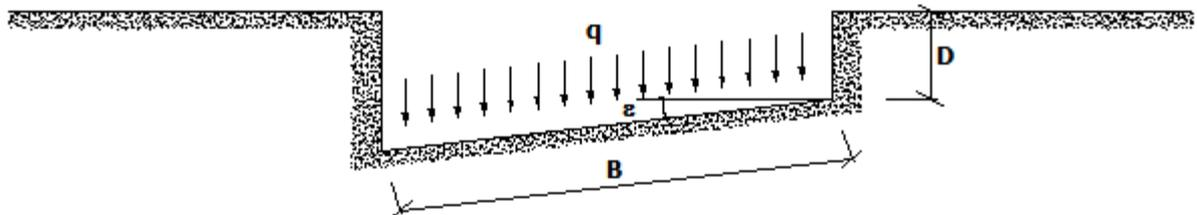
**Calcolo dei fattori di riduzione per rottura a punzonamento  $y_c, y_q, y_g$**
