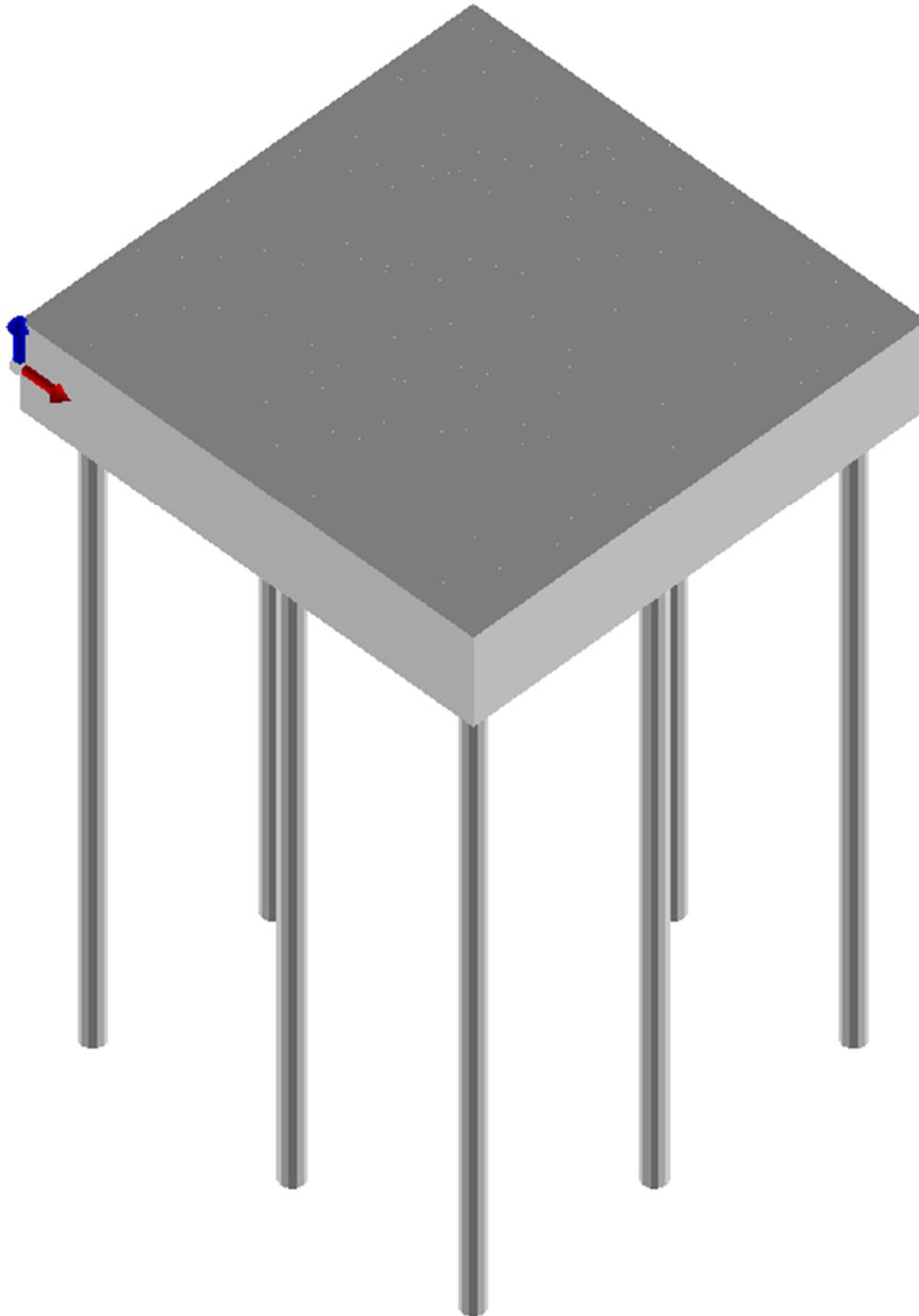
*Figura 5 – Modello solido platea con pali di fondazione*
