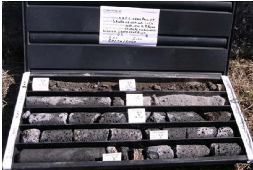
*Figura 1 - Sondaggio verticale con carotiere*
