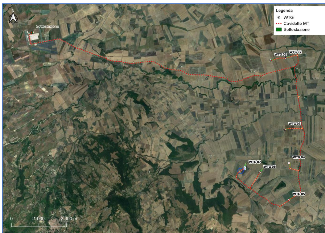
Figura 7 - layout impianto definitivo a n.7 aerogeneratori
