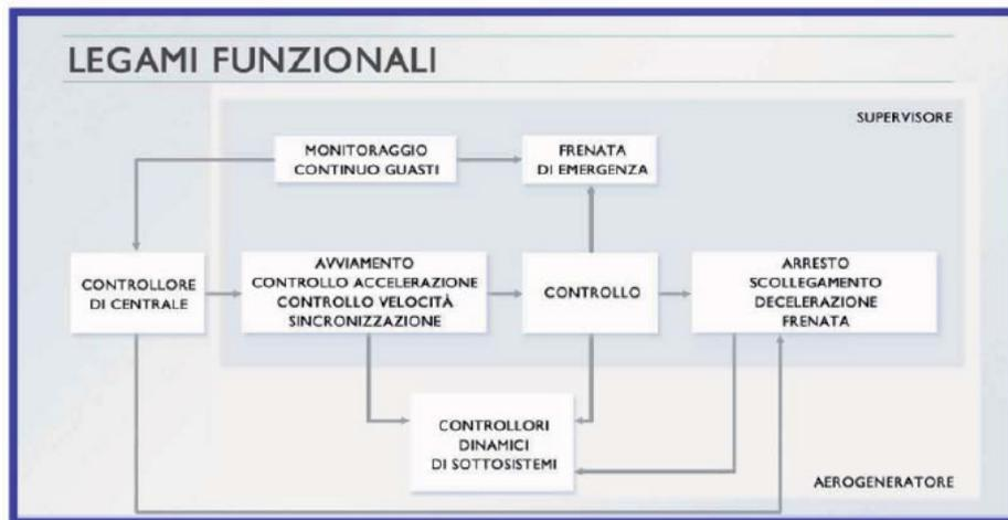
In ogni istante, se tutti i parametri di controllo sono nei limiti predefiniti di funzionamento, l'aerogeneratore può avviarsi automaticamente, ad esempio quando le condizioni di vento consentono di produrre energia, si mantiene in esercizio regolando quando necessario la potenza erogata attraverso il controllo del passo, oppure può comandare la cessazione della produzione in caso di vento troppo elevato, rientrando
