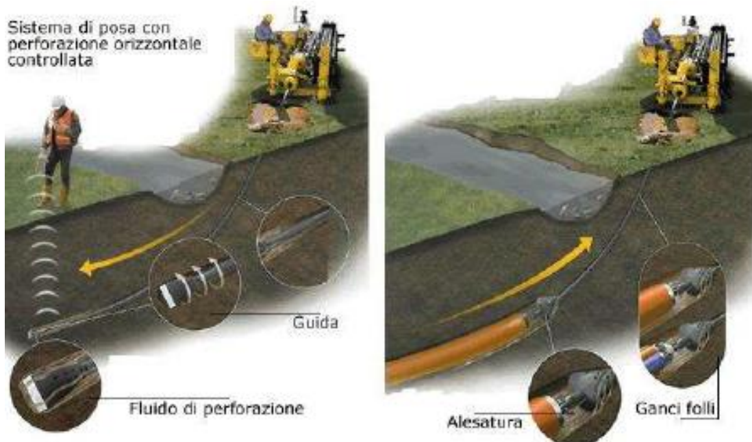
Posa in opera tubazione con trivellazione teleguidata
