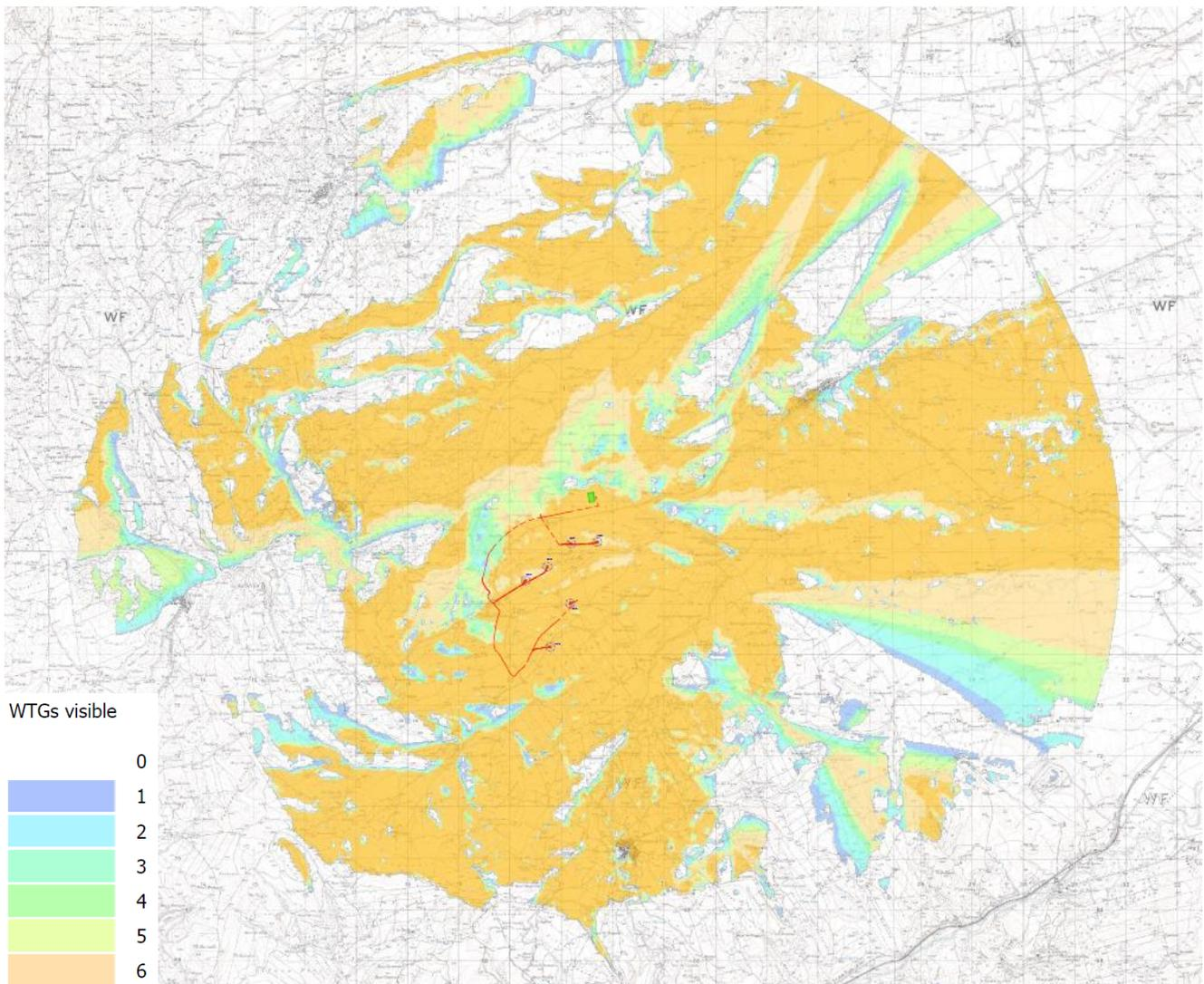
Figura 3 - Analisi di visibilità dell'impianto in progetto su IGM
