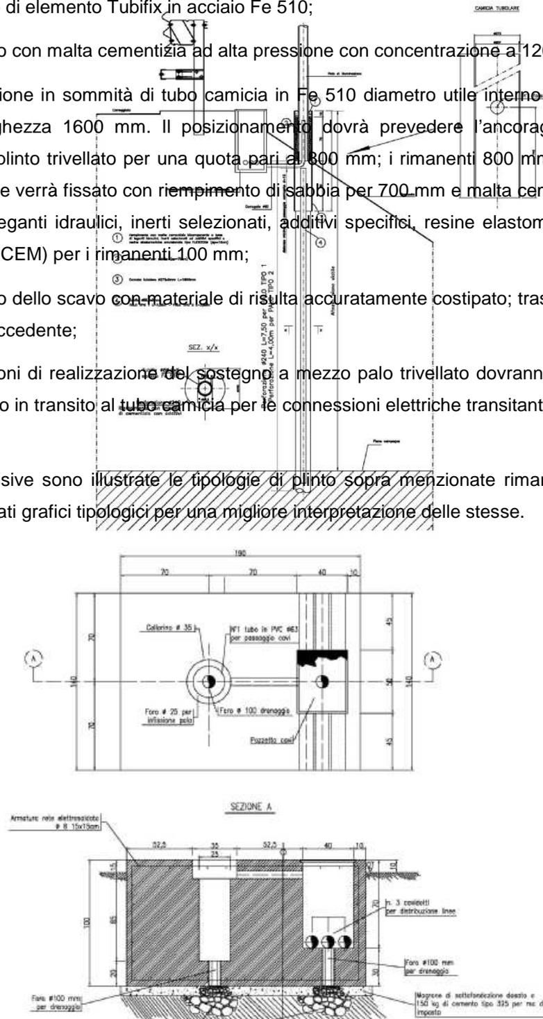
**Figura 4 - Tipologico plinto prefabbricato interrato per supporto palo**
