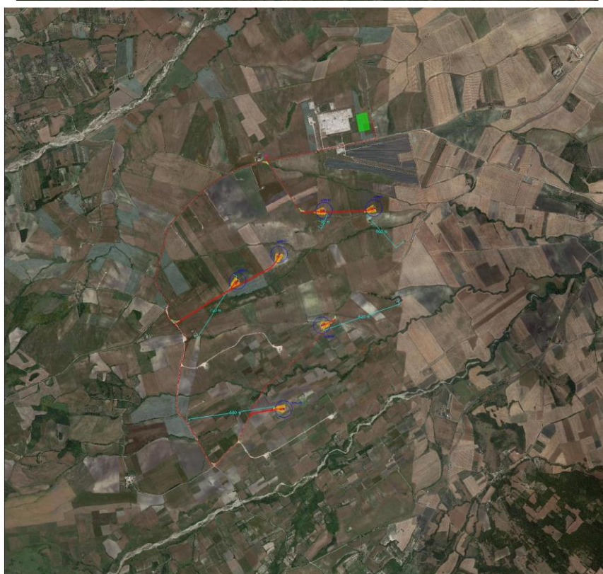
Distanza dalle strade (in verde) e dai fabbricati (in azzurro) degli aerogeneratori in località "Cancarro"
