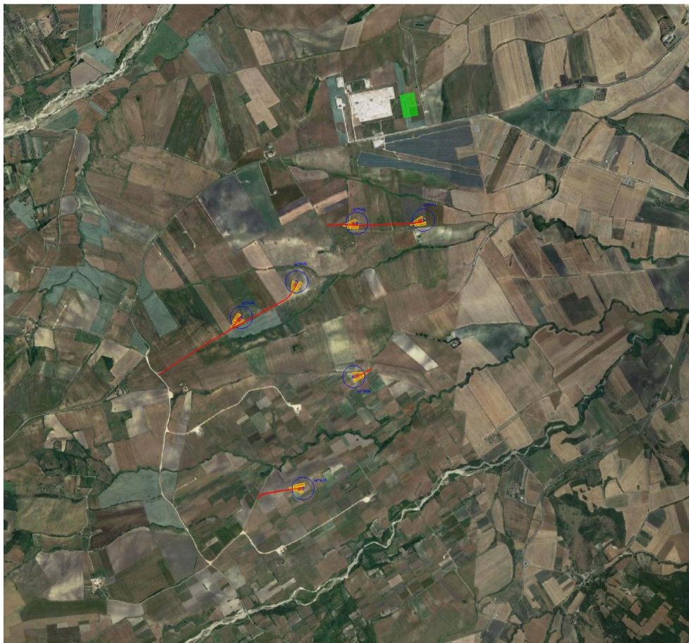
Area di impianto su ortofoto - in rosso la viabilità di nuova realizzazione per l'accesso alle torri
