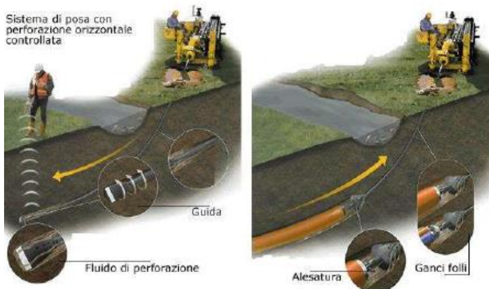
Posa in opera tubazione con trivellazione teleguidata
