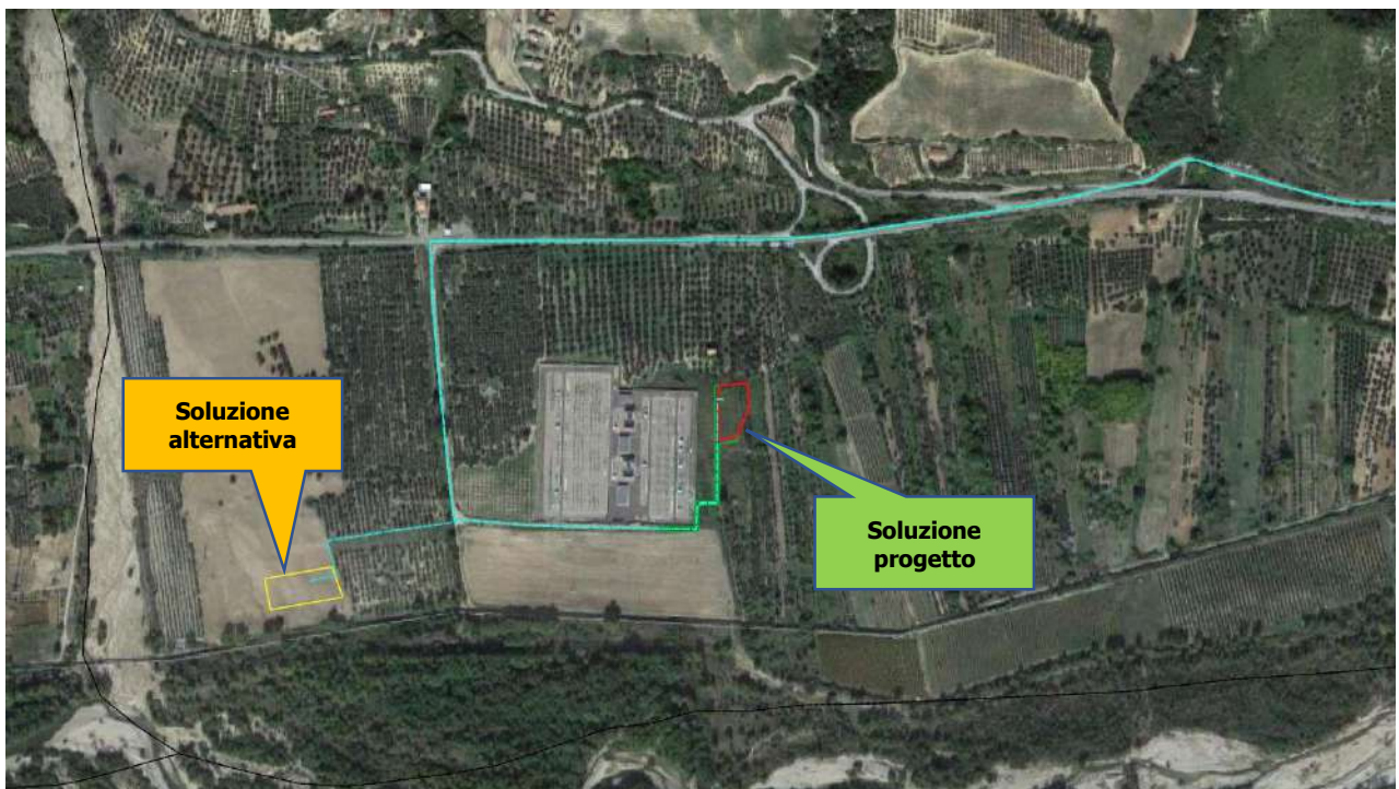
Figura 4-10: Analisi alternative posizione sottostazione
