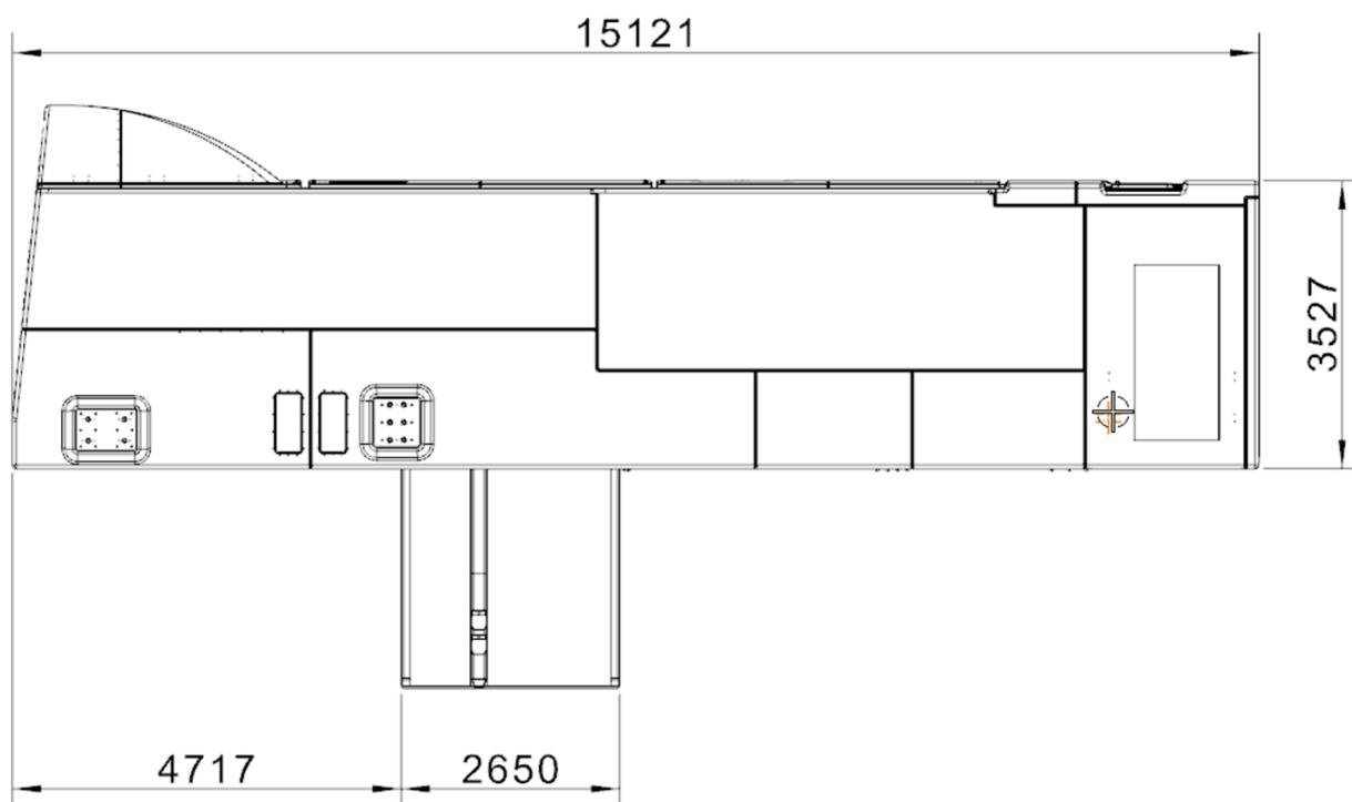
**Figura** Errore. Nel documento non esiste testo dello stile specificato.-2: **Tipico navicella WTG**
