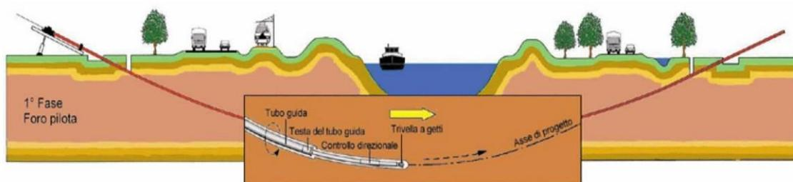
**Figura 2-2 Schema della fase di realizzazione del foro pilota.**
