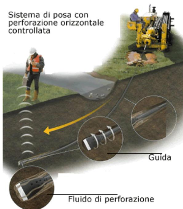
**Figura 2-1 Sistema di trivellazione orizzontale controllata (T.O.C.)**
