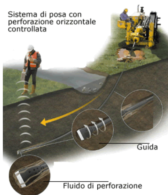
Figura 1- Sistema di trivellazione orizzontale controllata (T.O.C.)
