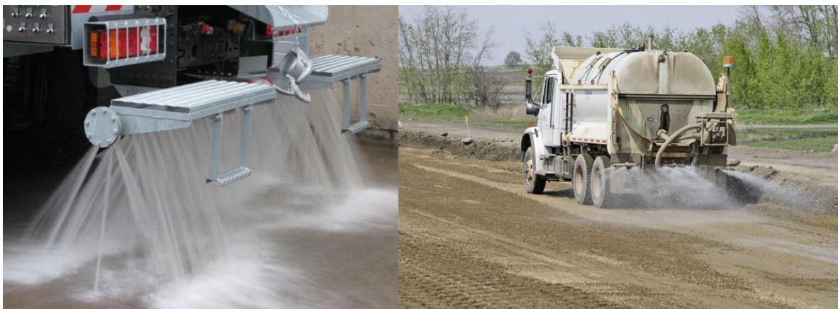
Figura 8-2: Automezzo per la bagnatura delle piste sterrate
