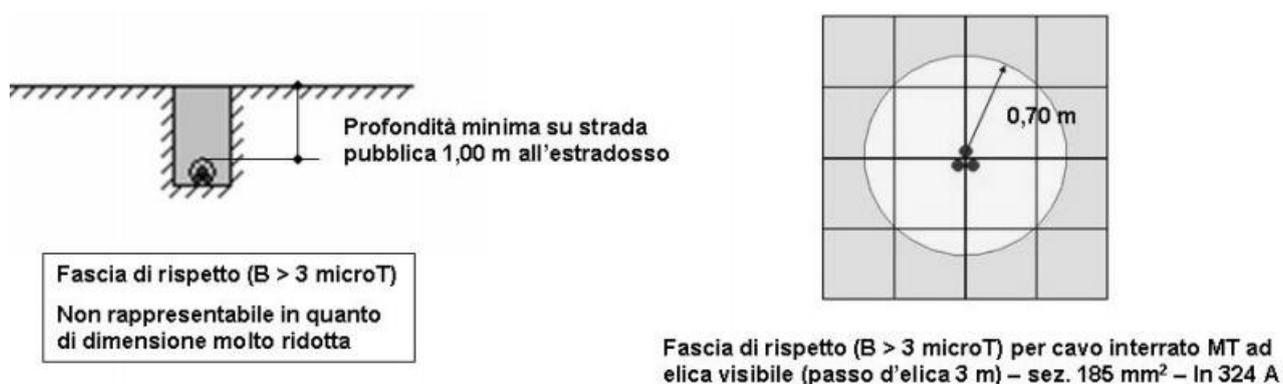
In particolare, nel paragrafo 7.1 della norma CEI 106-11 per le linee MT in cavo cordato ad elica visibile, si descrive che per la ridotta distanza tra le fasi e la loro trasposizione, dovuta alla cordatura, fa sì che l'obiettivo di qualità di 3  $\mu\text{T}$ , anche nelle condizioni limite di conduttori di sezione maggiore e relativa "portata nominale", venga raggiunto già a brevissima distanza (50÷80 cm) dall'asse del cavo stesso.
