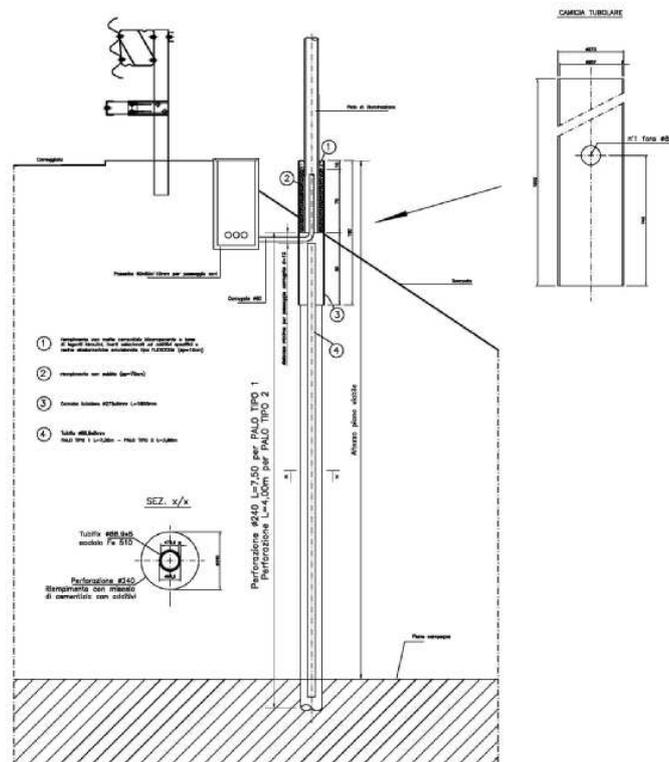
**Figura 3 - Tipologico plinto con palo trivellato**
