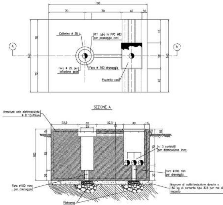
**Figura 2 - Tipologico plinto prefabbricato interrato per supporto palo**
