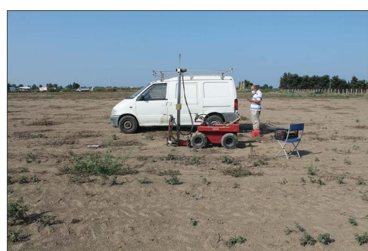
Ubicazione della prova penetrometrica dinamica Pd17
