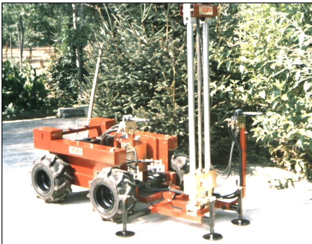
Fig. 30 – Penetrometro dinamico modello "TG 30/20" prodotto dalla ditta PAGANI
