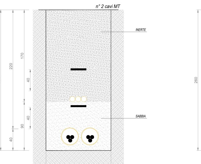
Sezione scavo cavidotto linea C1
