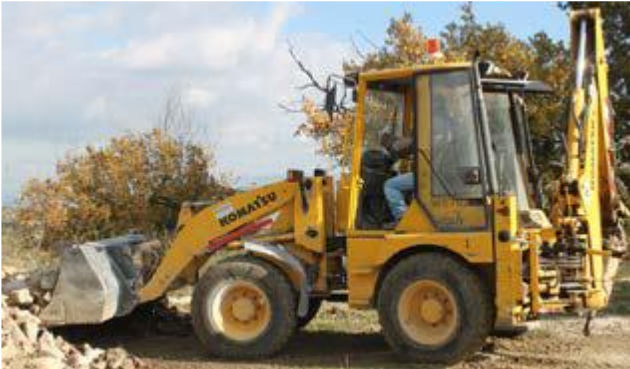
Escavatore caricatore (Terna)
