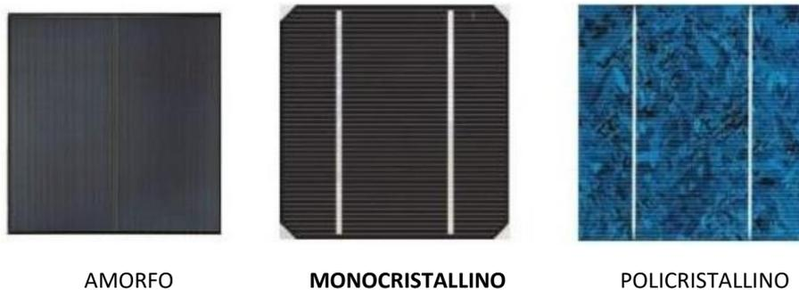
Di contro, i pannelli fotovoltaici costituiti da celle in silicio policristallino sono caratterizzati esteticamente da tipica una colorazione bluastra non uniforme. L'effetto estetico di un pannello in silicio policristallino, specialmente se posto su superfici visibili – come, ad esempio, falde di tetto architettonicamente importanti per l'equilibrio di design di un edificio – è più impattante rispetto ai pannelli di colore nero compatto della tecnologia con silicio monocristallino.
