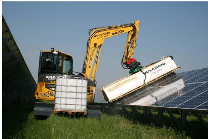
*Esempio di sistema di lavaggio moduli fotovoltaici*
