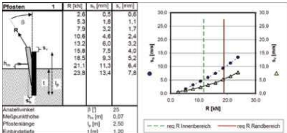
Per la fondazione si utilizzano profili di infissione zincati a caldo in diverse classi dimensionali. La forma di palificazione appositamente sviluppata garantisce un'infissione ottimale nel terreno con simultanea rigidità a flessione massima. In questo modo si ottiene che le forze di infissione possono
