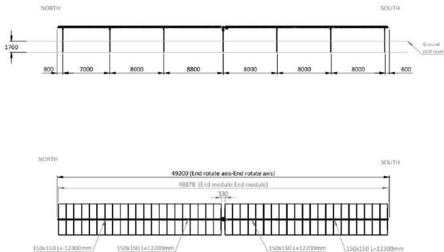
Sono costituite da un montante verticale in acciaio zincato da una testata di supporto alla fondazione su cui vengono installati gli attuatori lineari e gli arcarecci in alluminio orizzontali su cui vengono posizionati i moduli.
