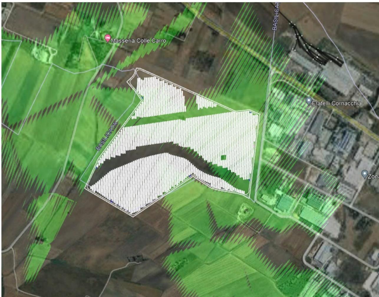
***Analisi di visibilità dell’impianto da S.P. 271-Ingrandimento***
