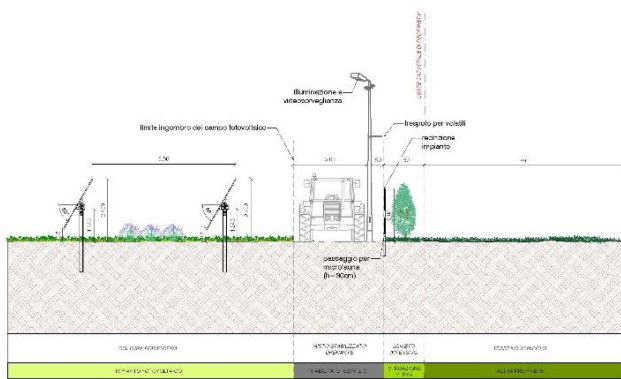
Figura 4-4: Sezione tipo misure di mitigazione
