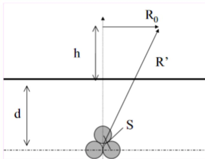
Considerata quindi la disposizione spaziale delle terne e fissando l'asse centrale del sistema con la terna centrale si può calcolare il campo magnetico generato dall'elettrodotto interrato attraverso la somma dei singoli contributi di ogni terna. La corrente utilizzata nel calcolo è pari alla portata nominale della singola terna pari a 460A.
