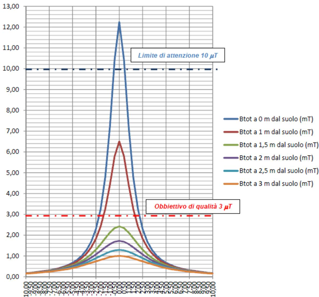
Il grafico mostra come nel caso in esame, l'obiettivo di qualità pari a 3 microtesla al livello del suolo è raggiunto ad una distanza dall'asse della linea pari o superiore a 2.5m. Quindi come valore cautelativo possiamo fissare una fascia di rispetto dall'asse della linea pari a 3m. Resta sempre ben inteso che nel caso specifico la linea di MT a 30kV sarà interrata su viabilità pubblica locale (strade comunali e/o vicinali) e le distanza dalle eventuali abitazioni sarà sempre superiore a 3m.
