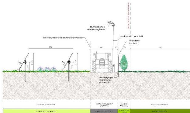
**Figura 3-3: Sezione tipo misure di mitigazione**
