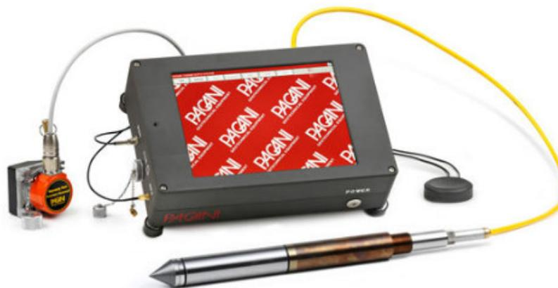
Figura 16: Strumentazione utilizzata per la prova CPTU
