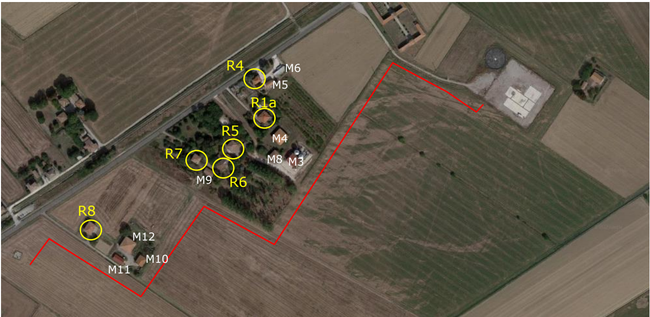
Figura 7 – Ricettori più prossimi all'area di cantiere per la realizzazione della condotta di allaccio alla rete
