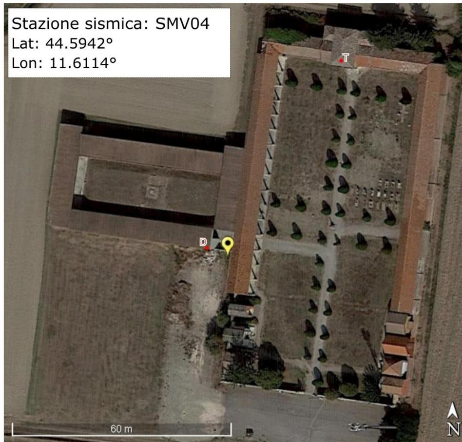
**Figura 11** Ubicazione della stazione sismica SMV04. La stazione temporanea è indicata dalla lettera T mentre l'ubicazione della stazione definitiva è indicata dal *marker* in giallo (pozzetto d'ispezione) e dalla lettera D (digitalizzatore).
