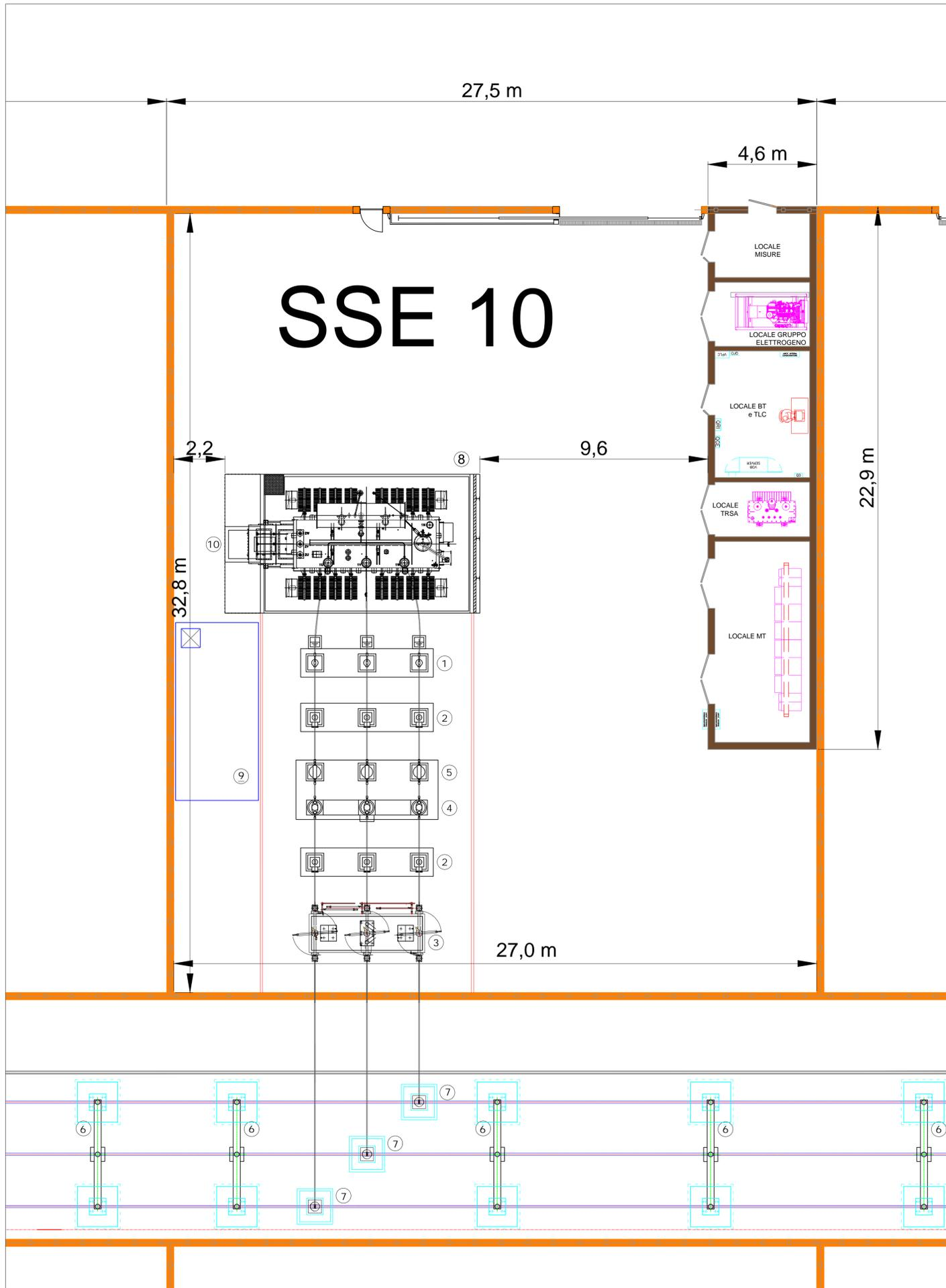
Planimetria elettromeccanica Sottostazione Elettrica Produttori 30/150 kV (scala 1: 500)
