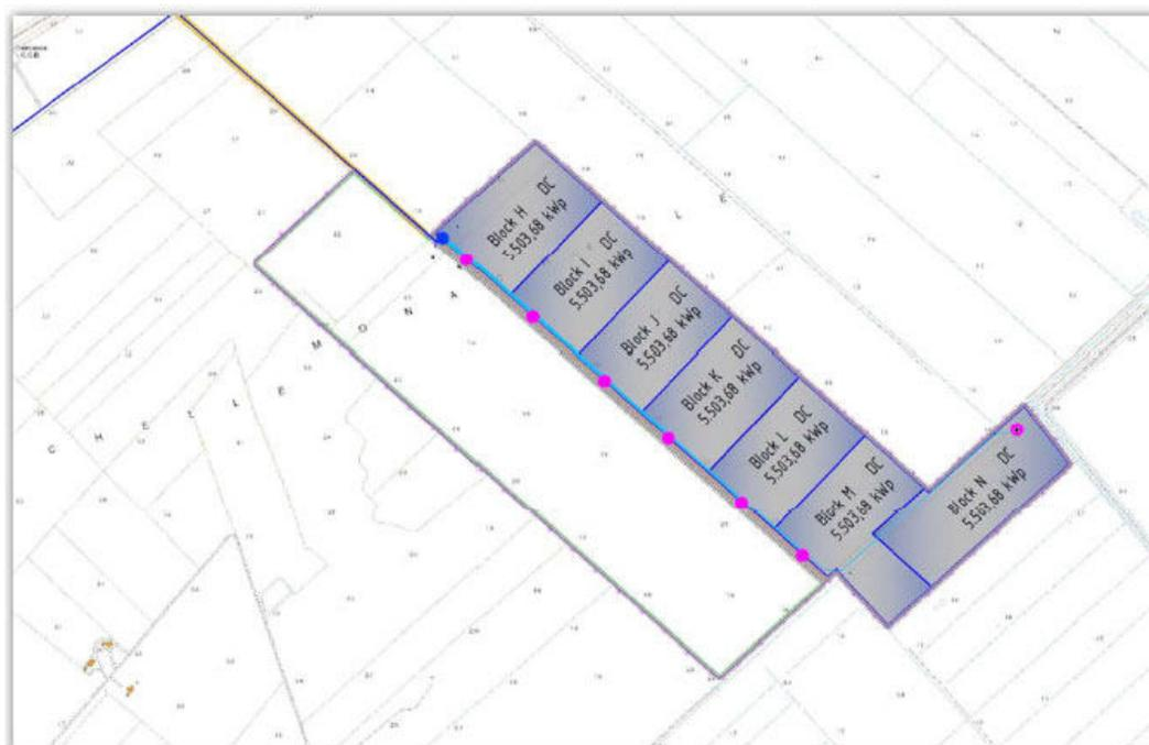
Layout del Sottopiamento EST” con identificazione dei vari subcampi (da H a N); in magenta, la posizione delle Stazioni di conversione/trasformazione; in blu, la posizione della cabina master “cabina di Raccolta OVEST”.
