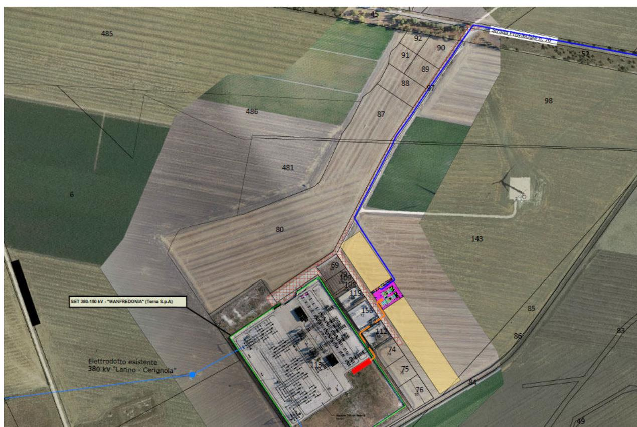
**Inquadramento su ortofoto-catasto delle opere di Rete: in blu, l'elettrodotto dorsale MT 30kV; in Magenta, la SSE Produttore; in arancio, l'elettrodotto AT 150kV; riquadrata in rosso, la posizione dello Stallo 150kV assegnato.**
