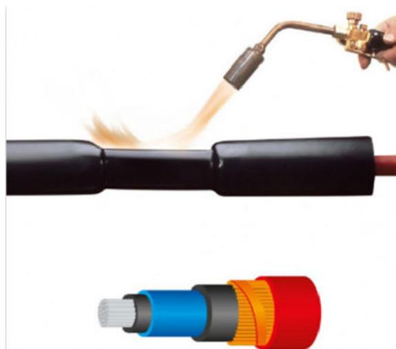
Schema di esecuzione di un giunto MT
