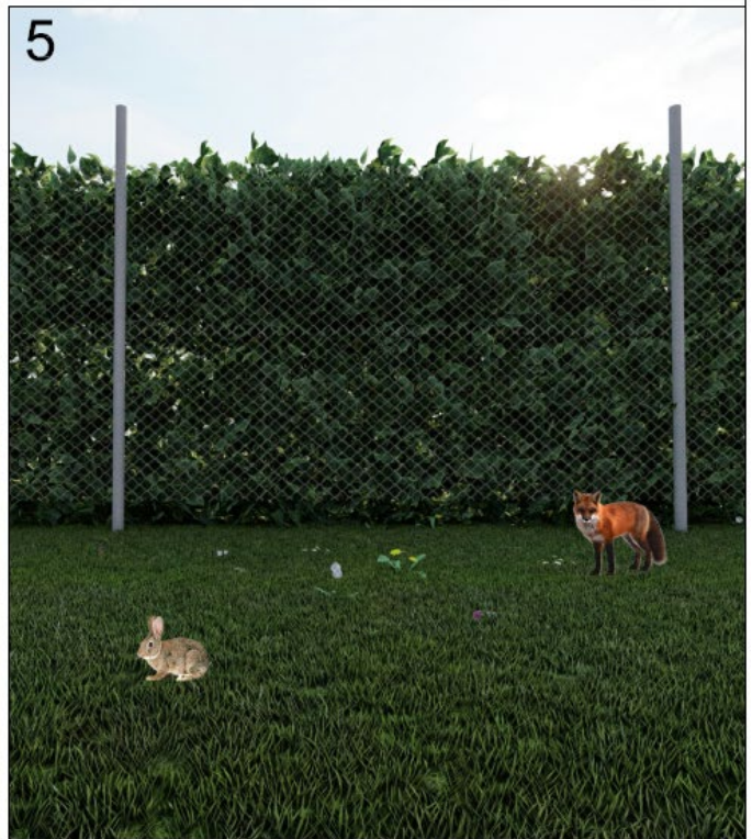
Fig.4 – Particolari dell'area dopo la messa in opera dell'impianto fotovoltaico. La recinzione sarà sollevata dal terreno di 20 cm.
