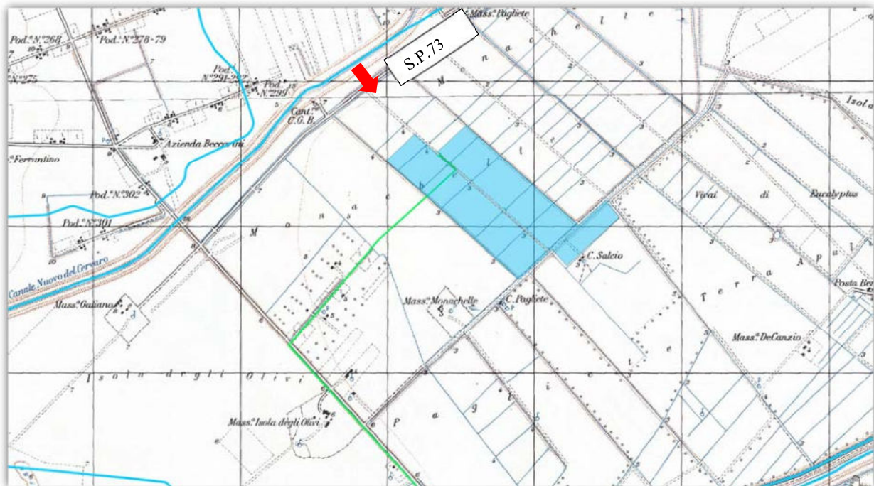
Fig. 3. Dettaglio planimetrico su CTR - area Parco Fotovoltaico, in località "MONACHELLE". La freccia rossa indica il punto in cui si imbocca la strada sterrata che dalla S.P. 73 conduce al progettato Generatore; con tratto in verde si distingue il percorso progettato dell'elettrodotto dorsale, tracciato su terreni privati prevalentemente in adiacenza alla viabilità esistente.
