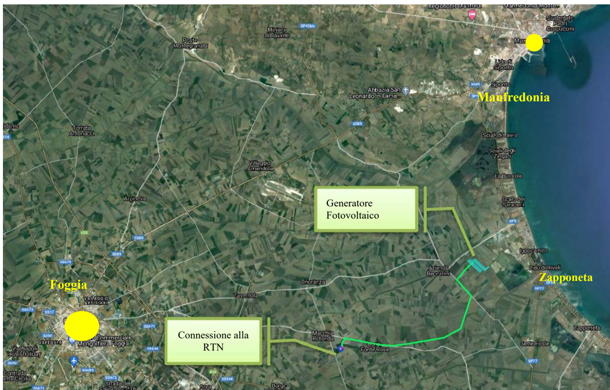
Fig. 1. Inquadramento di ampio raggio su ortofoto dell'area di intervento, situata all'incirca a circa 15km a SUD di Manfredonia; in celeste, la centrale fotovoltaica; in verde, il percorso dell'elettrodottto dorsale, che si sviluppa per circa 17km prevalentemente lungo rete viaria esistente; a SUD-Ovest la Sottostazione Produttore, nei pressi della esistente Stazione elettrica di Trasformazione SET-TERNA 380/150kV.
