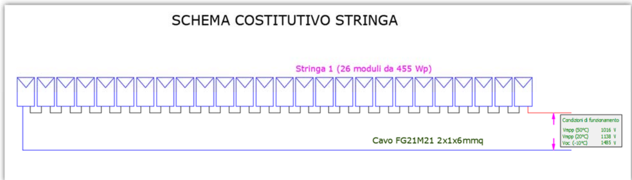
Fig. 2. Particolare serie moduli fotovoltaici
