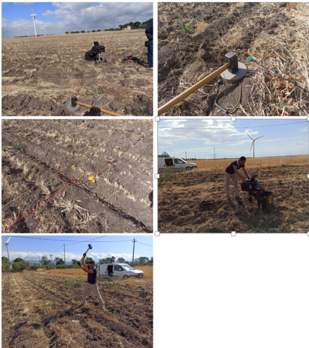
Fig. 1.4: Documentazione fotografica Indagini Sismiche Re.MI. - MASW
