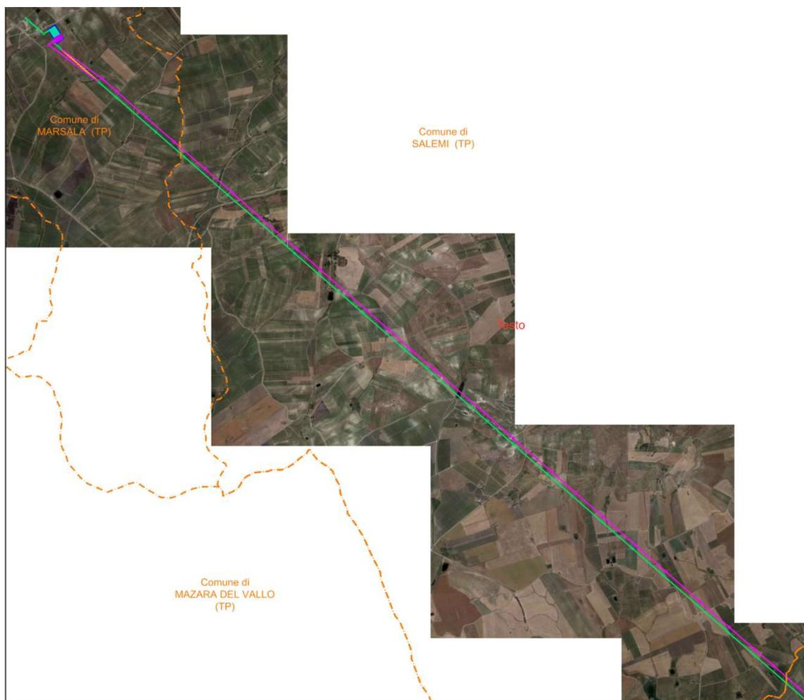
Fig. 2 Individuazione del Nuovo collegamento aereo 220 KV su Ortofoto *primo tratto*.
